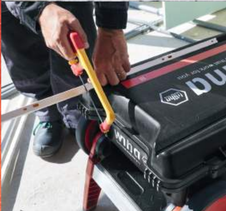
V-alakú bevágás skálával a koffer fedelében
