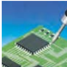
Löten zweier gegenüberliegender Ecken des Bauteils mit dem LötKolben
