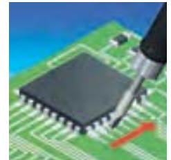
Verlöten der Leads des ICs mit den JBCSpezialspitzen für das Löten von SMD bestückten ICs
