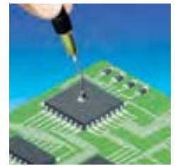
Platzierung des Bauteils
