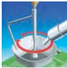
Entlöten mit Heißluft
