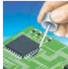
Aufbringen des Flussmittels auf die Pads und Leads des ICs
