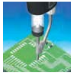
Reinigung der Leiterpads mit dem Entlötkolben
