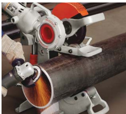
258-as modell gyököléshez használatos csőgörgővel. Ehhez a művelethez két ember ajánlott
