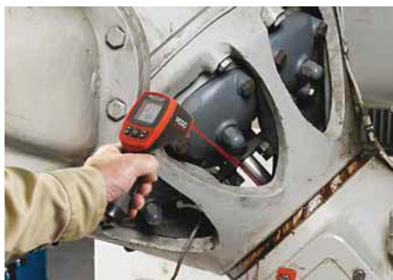
Diagnosztizálja kopó alkatrészek hőmérsékletét, a megelőző üzemi karbantartás érdekében.
