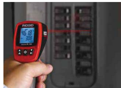
Ellenőrzi a biztosíték vagy áramkör túlmelegedését, melyet a túlterhelt áramkörök okozhatnak.
