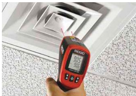
Mérje a hőleadás hatékonyságát, hogy áramlási rendszerekben feltárhassa és lokalizálhassa a hőveszteségeket.
