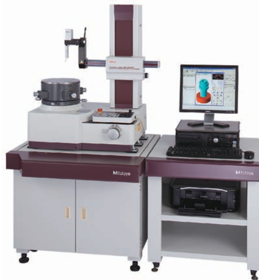
RA-2200 CNC + rezgésszigetelő asztallal [12AAK110] és oldalsó asztal [12AAL019]
