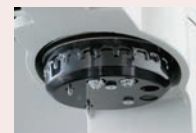
Revolverfej 2 behatolótesttel és 4 objektívvel
