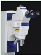
Laser Auto Focus optikai tubus
