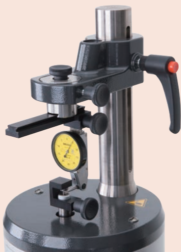
Mérőórák kalibrálása (Karos típus) opcionális tartozékokkal
