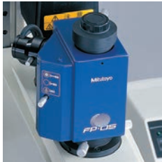
Focus pilot FP-05 Fókuszálás segítő rendszer
