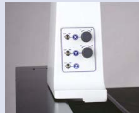
Pneumatikus tengelyrögzítés és finompozicionáló gombok
